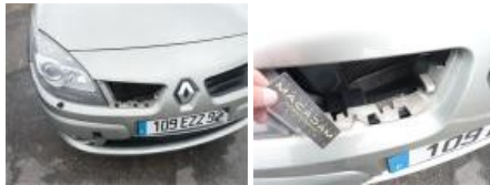
Grille de pare-chocs AV M, Cassé, E - Remplacer
