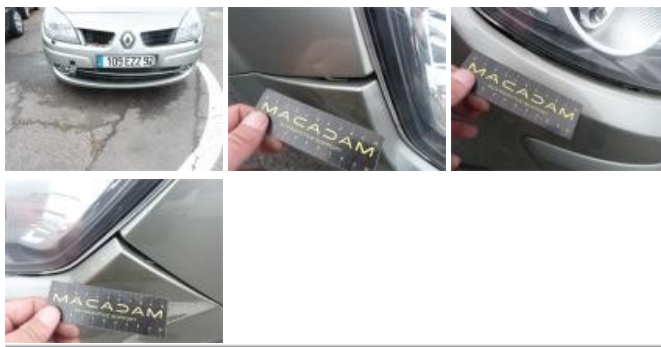
Grille d'auvent, Manque, E - Remplacer
