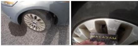
Pneu AVG, Usé, E - Remplacer
