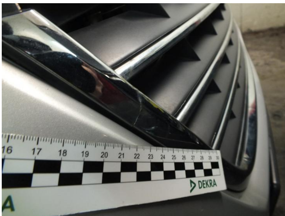
Fot. 36. KRATA WLOTU POWIETRZA - PĘKNIĘCIE
