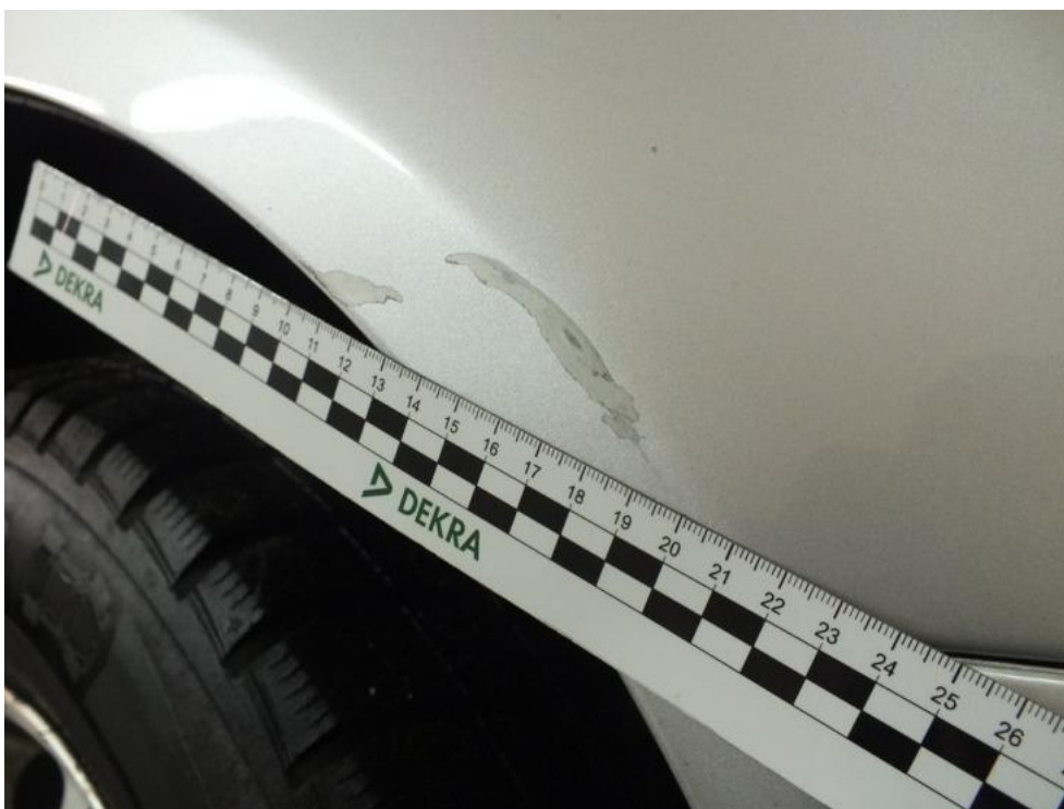
Fot. 17. BŁOTNIK PP - ZARYSOWANIE
