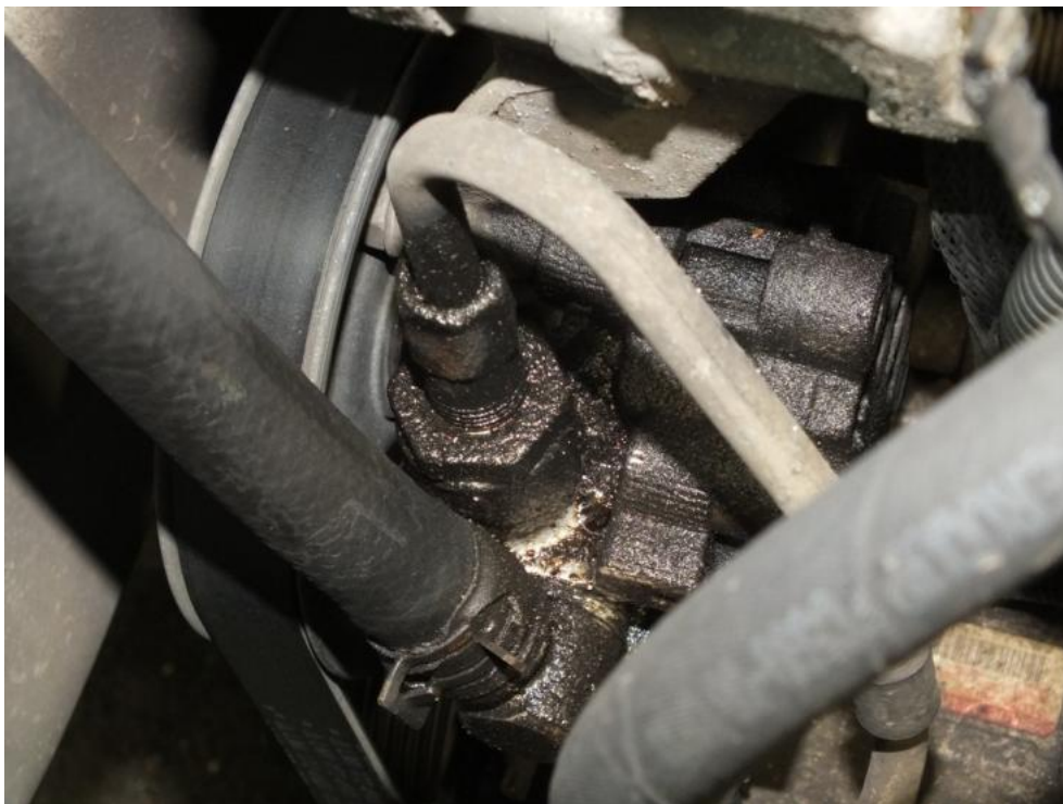
Fot. 37. POMPA WSPOMAGANIA - WYCIEKI OLEJU
