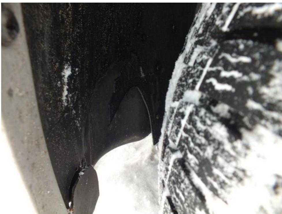
Fot. 42. NADKOLE PL - UBYTKI MATERIAŁU
