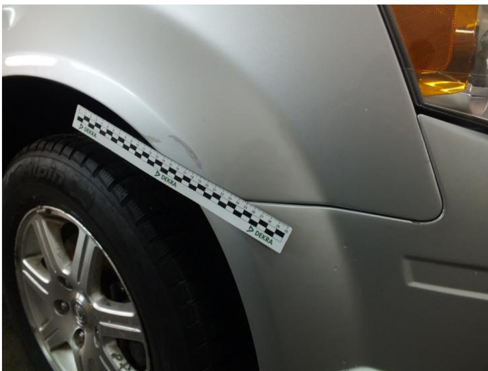
Fot. 18. BŁOTNIK PP - ZARYSOWANIE
