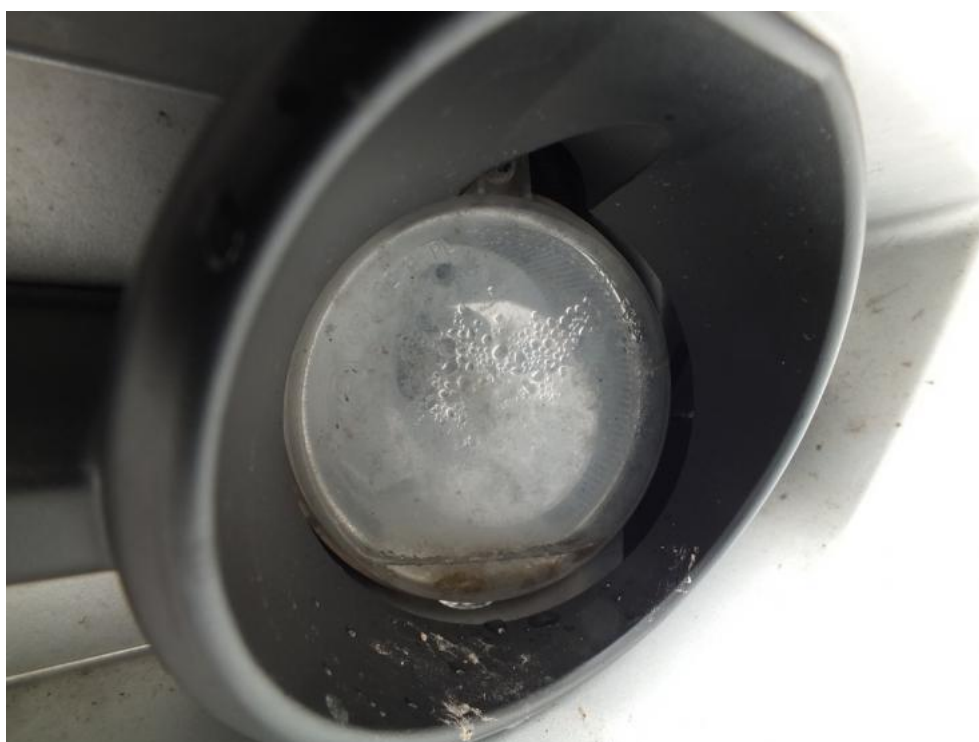
Fot. 40. REFLEKTOR PRZECIWMGIELNY PL - NIESZCZELNOŚĆ
