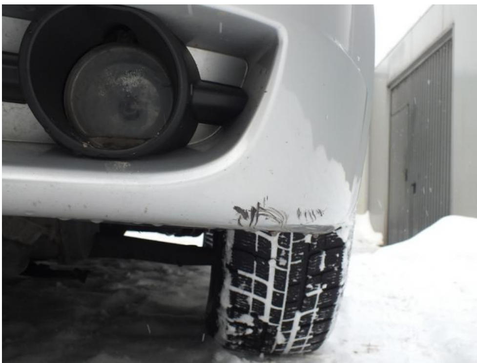
Fot. 41. ZDERZAK P - ZARYSOWANIE
