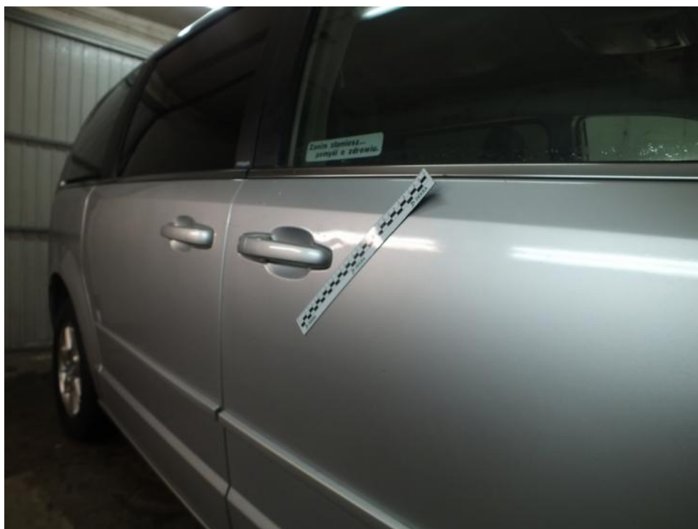
Fot. 20. DRZWI PP - WGNIECENIE
