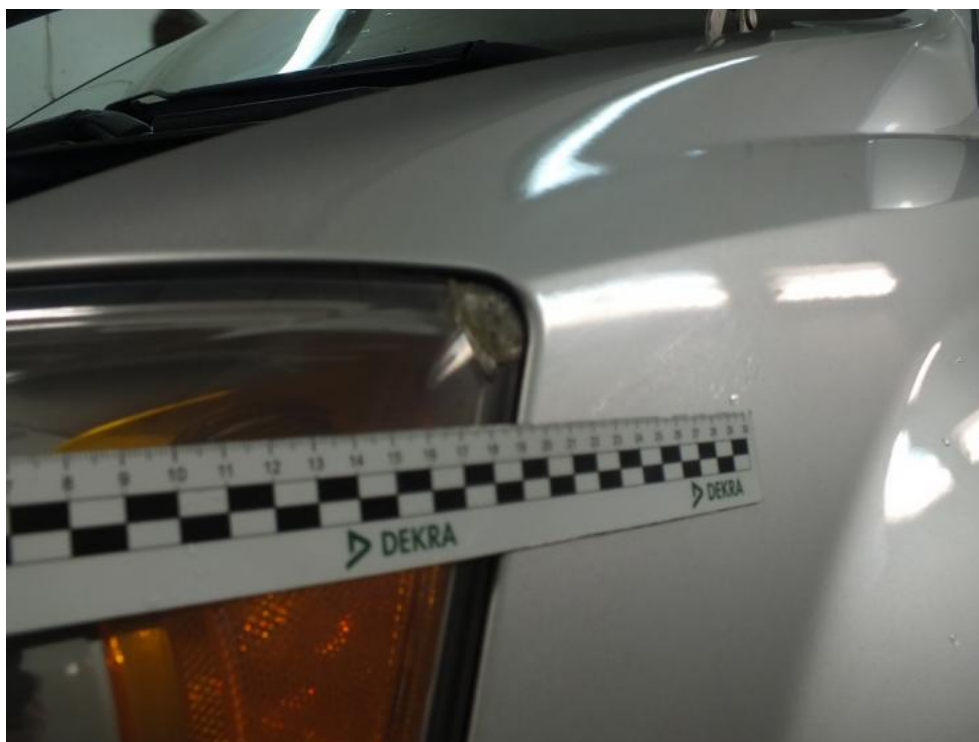
Fot. 32. LAMPY PRZEDNIE - UBYTEK MATERIAŁU
