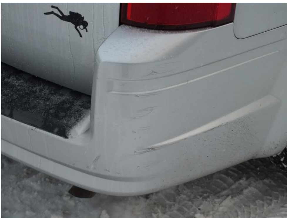
Fot. 25. ZDRZAK T - ZARYSOWANIE
