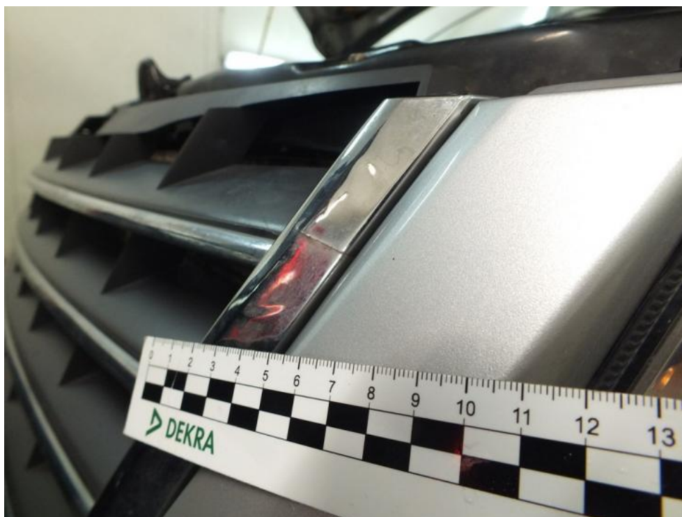
Fot. 35. KRATA WLOTU POWIETRZA - PĘKNIĘCIE
