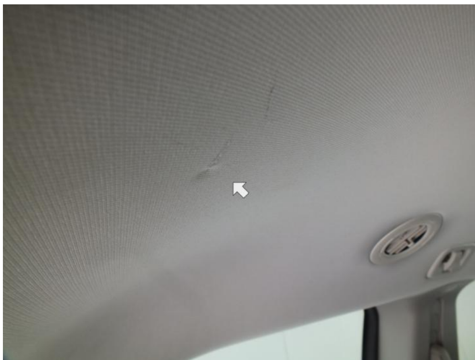
Fot. 39. PODSUFITKA - ROZERWANIE
