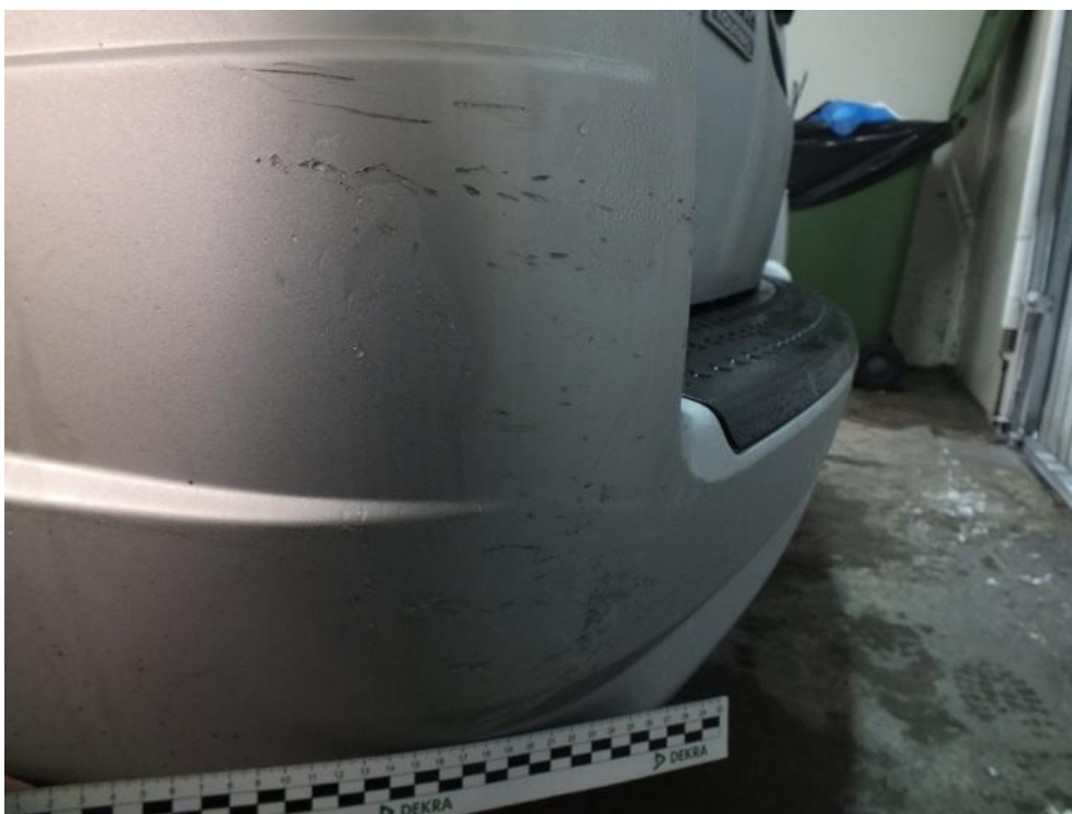
Fot. 24. ZDERZAK T- ZARYSOWANIE
