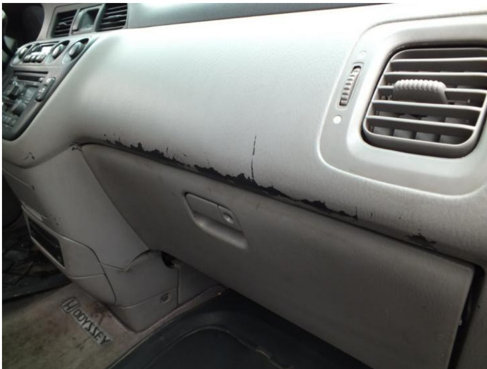
Fot. 19. DESKA ROZDZIELCZA - ZARYSOWANIA
