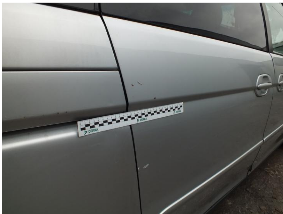
Fot. 29. DRZWI TP - KOROZJA
