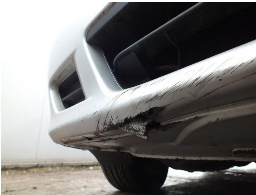
Fot. 34. ZDERZAK P - PEKNIĘCIE
