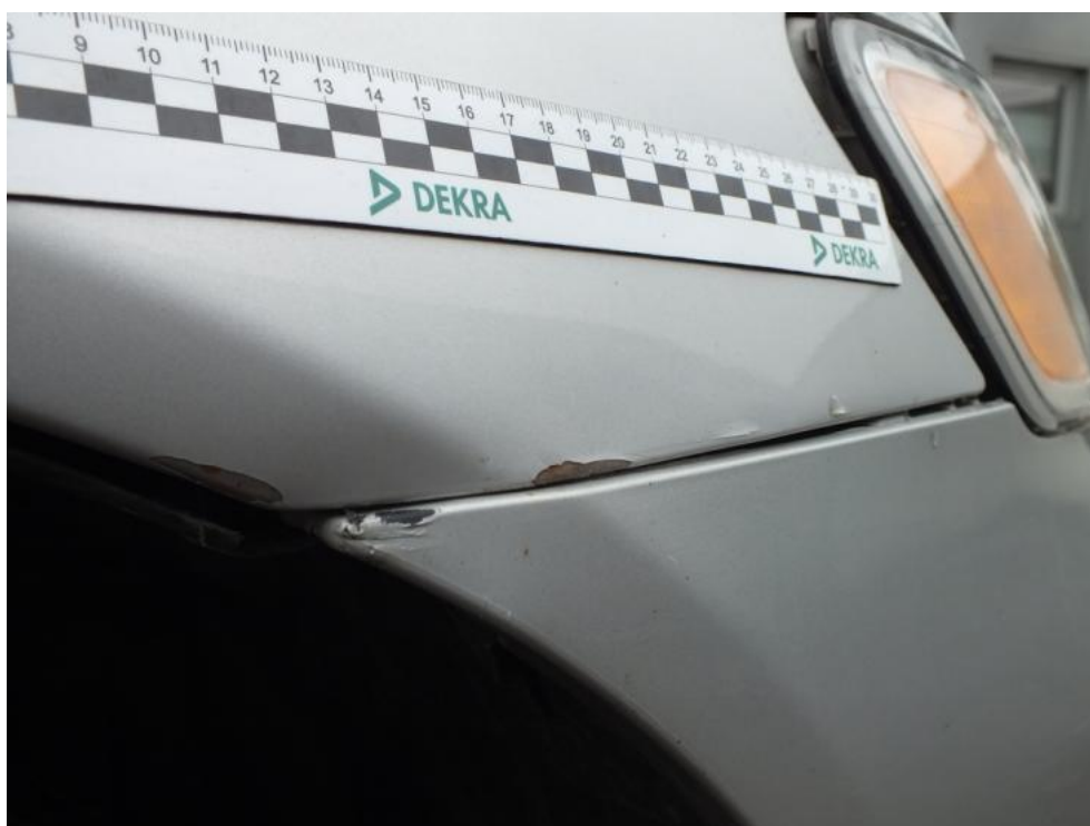
Fot. 31. BŁOTNIK PP - UBYTKI LAKIERU
