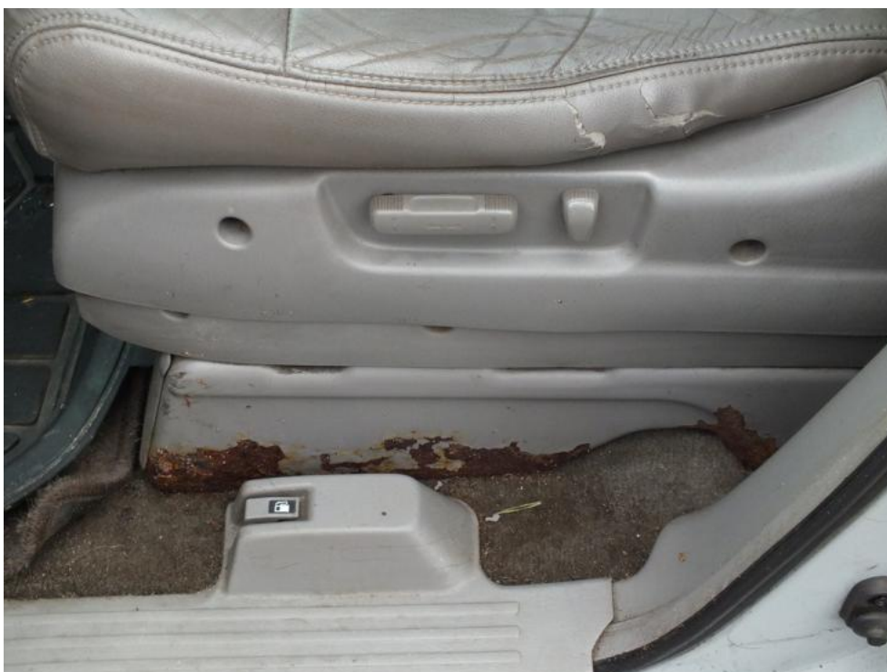
Fot. 22. FOTEL L - KOROZJA
