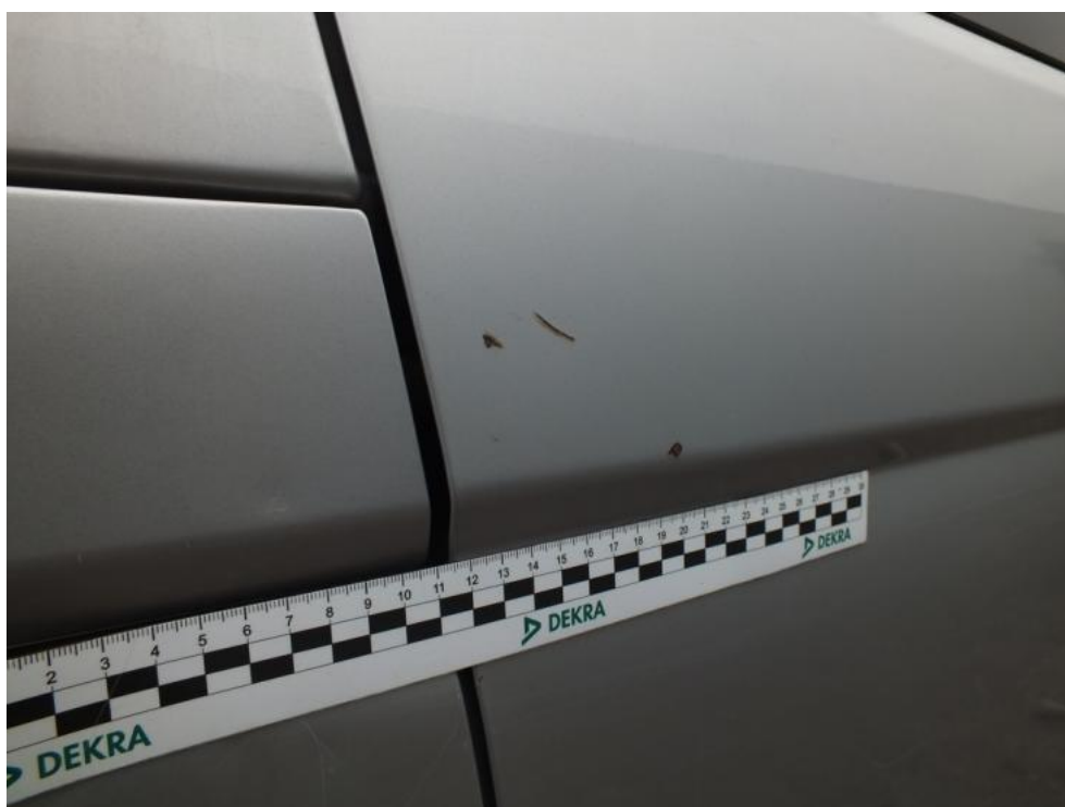
Fot. 28. DRZWI TP - KOROZJA
