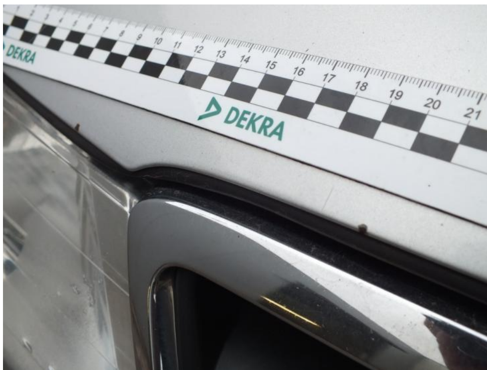
Fot. 35. POKRYWA SILNIKA - KOROZJA
