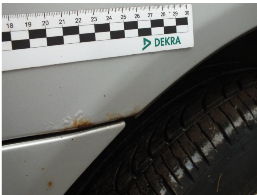
Fot. 26. BŁOTNIK TP - ŚLADY KOROZJI
