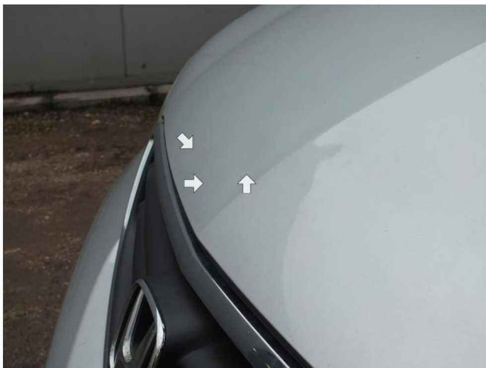
Fot. 36. POKRYWA SILNIKA - WGNIECENIE
