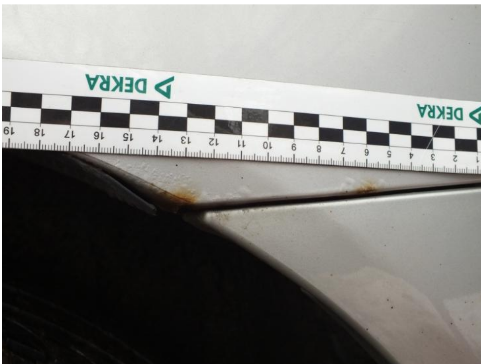
Fot. 40. BŁOTNIK TL - ŚLADY KOROZJI
