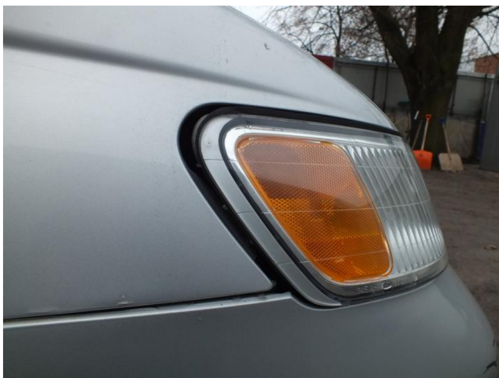
Fot. 32. LAMPY PP - NIENORMALNE ZAMOCOWANIE
