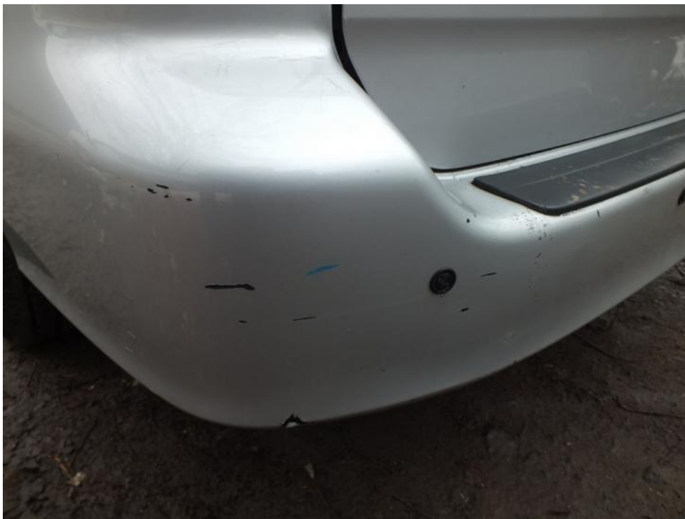
Fot. 39. ZDERZAK T - ZARYSOWANIE
