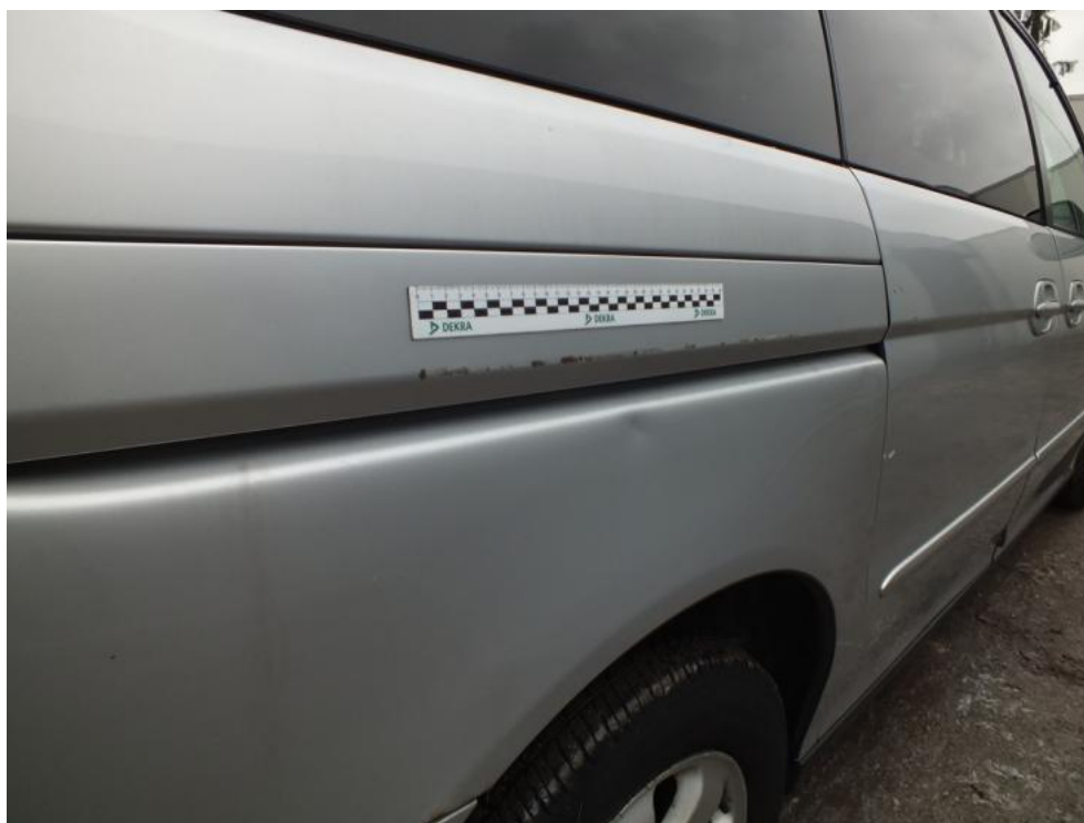
Fot. 25. OSŁONA PROWADNICY P - ŚLADY KOROZJI
