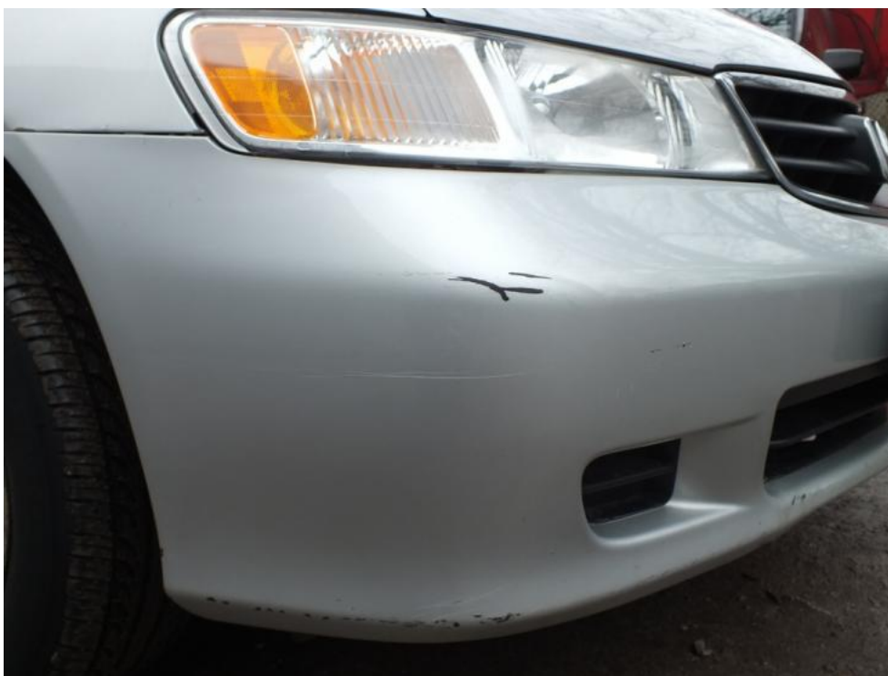
Fot. 33. ZDERZAK P - ZARYSOWANIE
