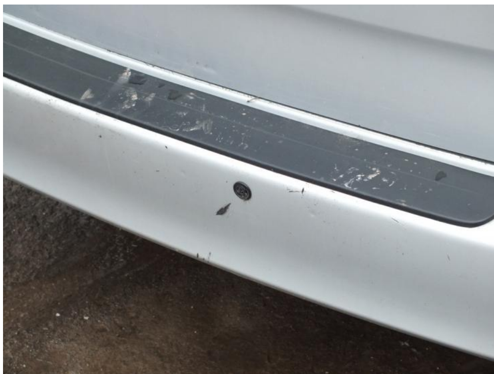
Fot. 38. ZDERZAK T - ZARYSOWANIE
