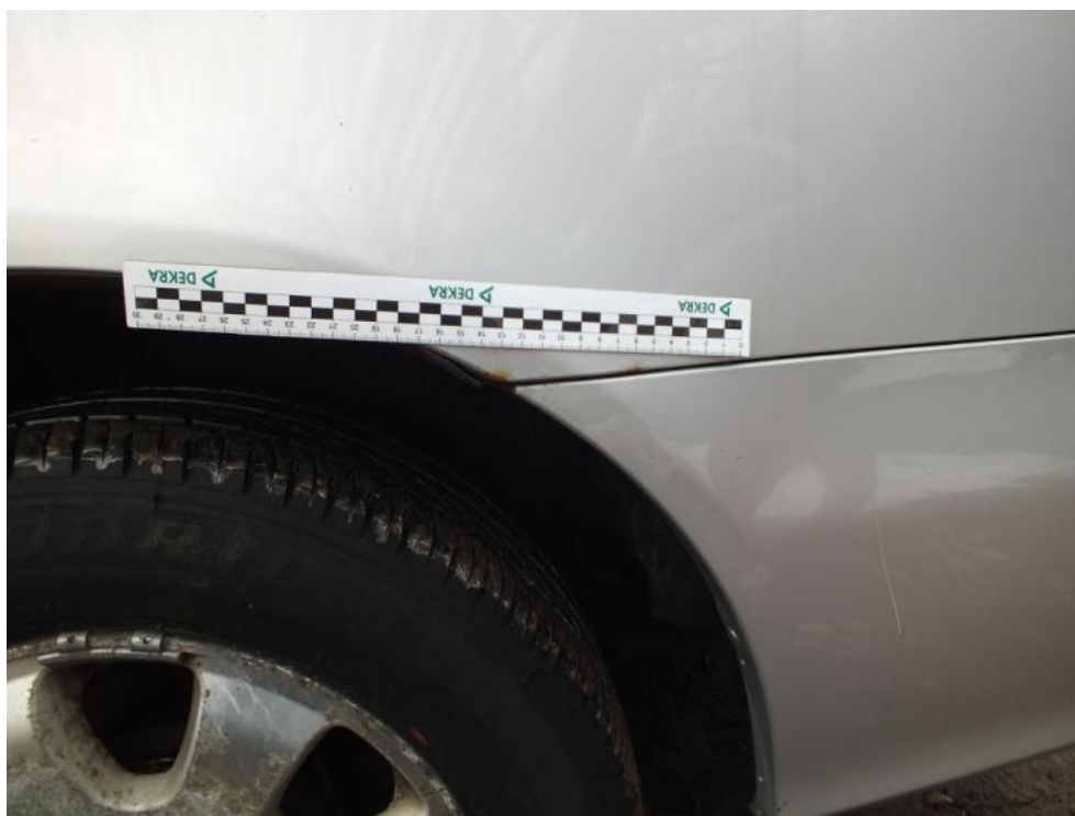
Fot. 41. BŁOTNIK TL - ŚLADY KOROZJI
