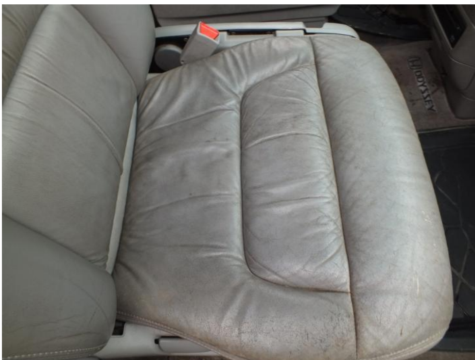
Fot. 20. OKŁADZINY TAPICERSKIE - ZABRUDZENIA
