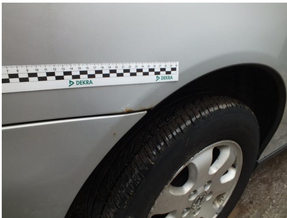
Fot. 27. BŁOTNIK TP - ŚLADY KOROZJI
