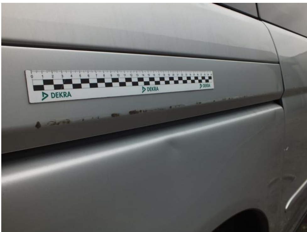
Fot. 24. OSŁONA PROWADNICY P - ŚLADY KOROZJI
